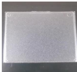
รูปที่ 3 ตัวอย่าง polymethylmethacrylate (PMMA) plate ที่ใช้ในการประเมินประสิทธิภาพของผลิตภัณฑ์ในการป้องกันรังสีอัลตราไวโอเล็ตหรือยูวี
