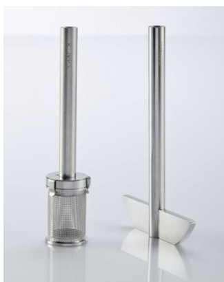
ภาพที่ 2 Apparatus 1 (Basket) และ Apparatus 2 (Paddle)
